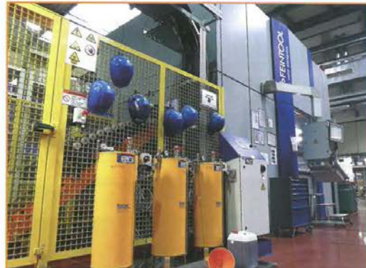
Debido a que en la prensa de corte fino tiene que procesar diferentes materiales, deben tenerse preparados también los distintos tipos de lubricante correspondientes. Por lo tanto, la instalación de lubricación está diseñada para tres medios lubricantes distintos. El cambio de lubricante se realiza de forma automática. Raziol, como especialista en lubricantes, ha suministrado a Feintool un sistema integral, que incluye el control de dosificación, un sistema de calefacción y la unidad de suministro de lubricantes (depósitos amarillos) (Foto: Kuhn)
