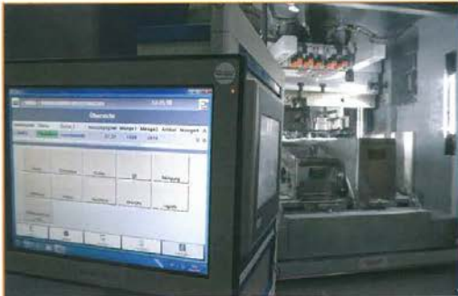
Panel de control de la prensa; desde aquí puede seleccionarse el lubricante deseado, según el tipo de pieza a estampar. También pueden memorizarse otros parámetros relevantes para la producción. En el fondo de la imagen una vista del espacio para el troquel (Foto: Kuhn)
