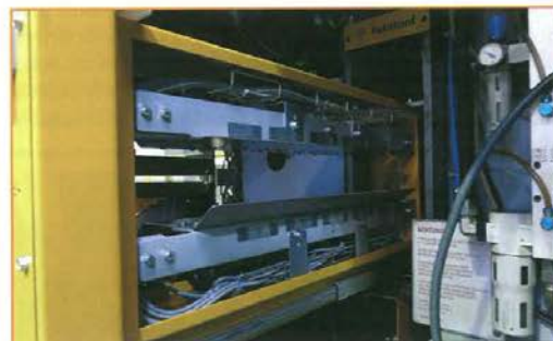
Vista de la cámara de pulverización en posición extraída; contiene todas canalizaciones y conexiones para el suministro de lubricante, aire a presión e impulso eléctrico necesarias para el engrase de la banda. Las barras de boquillas de construcción compacta están diseñadas para dar cabida a 9 boquillas con 50 mm de separación, para la anchura máxima lubricación de 450 mm. Las boquillas están firmemente acopladas a las barras de boquillas, por lo que el sistema no requiere tuberías (Foto: Kuhn)
