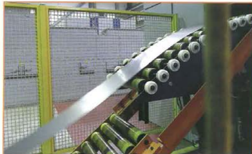
Antes del inicio del proceso de corte fino, las bandas se enderezan en una unidad de enderezado integrada (Foto: Kuhn)
