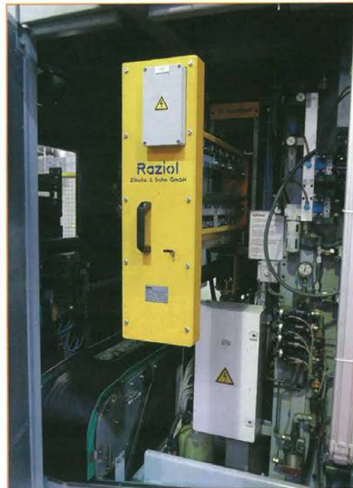
Detalle de la cámara de pulverización SKT de Raziol. Esta está integrada en el conjunto del sistema con su control de dosificación, calefacción y bastidor de suministros para tres lubricantes. Se utiliza para la lubricación sectorial o parcial del material de banda para la prensa de corte fino HFA. La cámara de pulverización puede extraerse telescópicamente del cajón de engrase previsto por el cliente, por ejemplo para facilitar tareas de limpieza y mantenimiento de la cámara (Foto: Kuhn)
