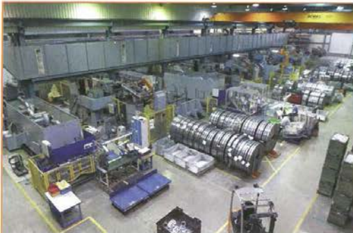
Vista de una de las naves de producción con prensas de corte fino Feintool-Schuler HFA 8800 (HFA = Prensa hidráulica de corte fino), con periférico para manipulación de bobinas (Foto: Kuhn)
