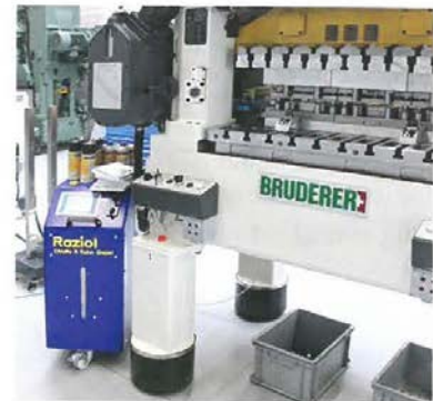
Präzise Schmierstoffdosierung mit der Raziol-Dosiereinheit. Bilder: Raziol Zibulla+Sohn
