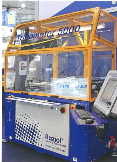
Prüfanlage „Tribometer 5000“ zur Ermittlung von Reibkennwerten. Bild: Raziol
