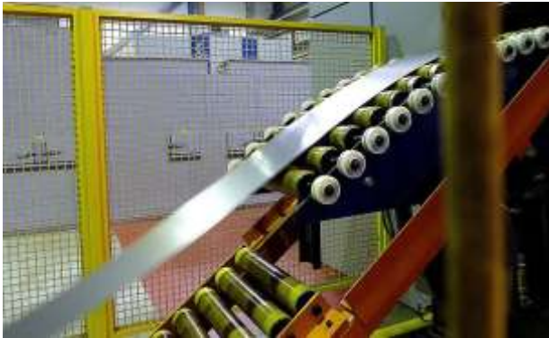
Bild 5: Über eine Schlaufenbrücke wird das Band gleichmäßig über den Vorschub in die Presse zugeführt. Bild: Kuhn
