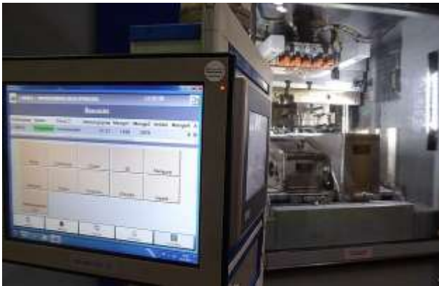
Bild 8: Das Bedienpult an der Presse; hier ist beispielsweise auch die Anwahl des gewünschten Mediums – je nach zu stanzendem Produkt – aber auch andere produktionsrelevante Parameter gespeichert. In Hintergrund ein Blick in den Werkzeugraum. Bild: Kuhn
