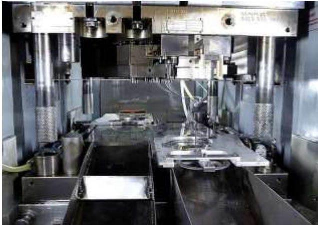
Bild 9: Ein Blick in den Werkzeugraum der HFA Feinschneidpressen. Bild: Kuhn
