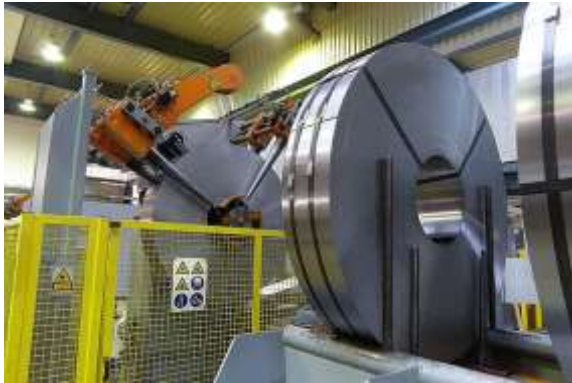
Bild 4: Die Coils, bis 400 mm Breite, werden auf einen verfahrbaren Ladewagen abgelegt und von hier aus der Abwickelhaspel zugeführt. Bild: Kuhn
