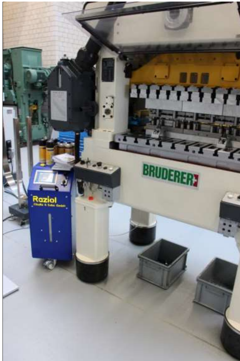
Bild: Präzision, Reduktion und Dokumentation: Moderne Schmierstoffdosierung mit der Raziol ® Präzisionsdosiereinheit. (Bild: RAZIOL)
