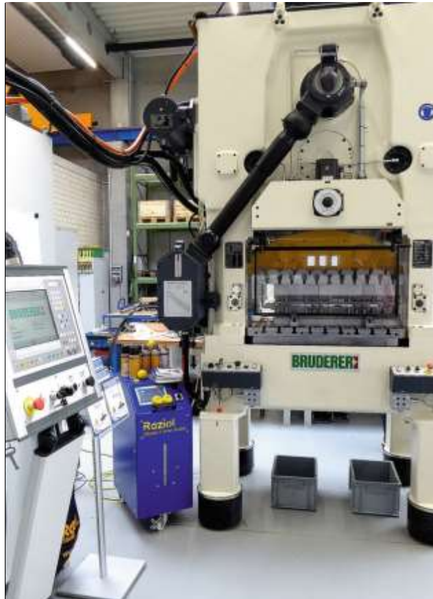
Bild: Präzision, Reduktion und Dokumentation: Moderne Schmierstoffdosierung mit der Raziol ® Präzisionsdosiereinheit (Bild: Dietmar Kuhn)
